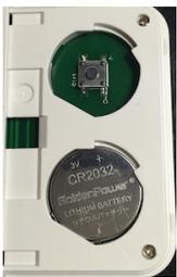
この装置はリチウムイオン電池CR-2032で動作します。（電池の型番は電池蓋の裏側にも貼ってあります）
