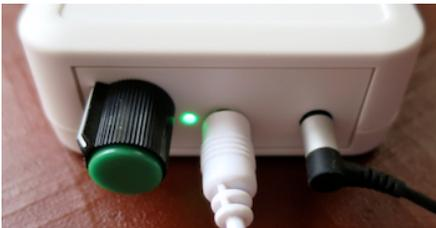
真ん中のジャックは写真のように外部入力ライン(付属)を接続します。
