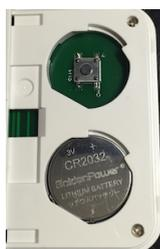
この装置はリチウムイオン電池CR-2032で動作します。サンプル電池が添付されています。電池を下図左側の方向で入れて下さい。しっかり押しこむと右図のようにきっちり収まります。
